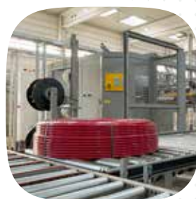
Estrusione di tubazioni in PE-RT
