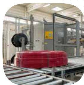
Estrusione di tubazioni in PE-RT
