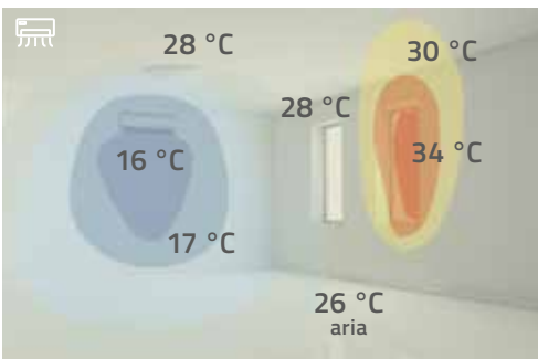
Confronto in raffrescamento tra sistema radiante e fancoil
