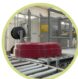
Estrusione di tubazioni in PE-RT
